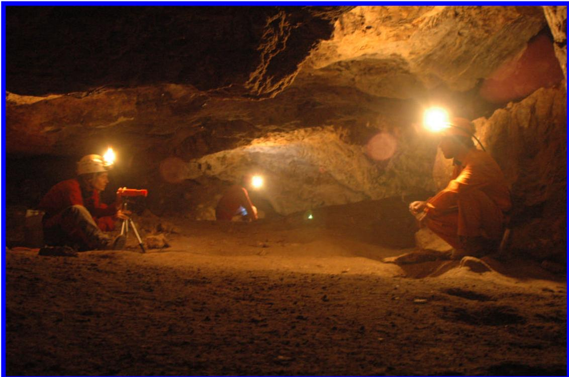
**Foto-6:** Topografía interior en la mina romana de *lapis specularis* de “La Quebrada” en Valparaíso de Abajo (Campos del Paraíso-Cuenca).
