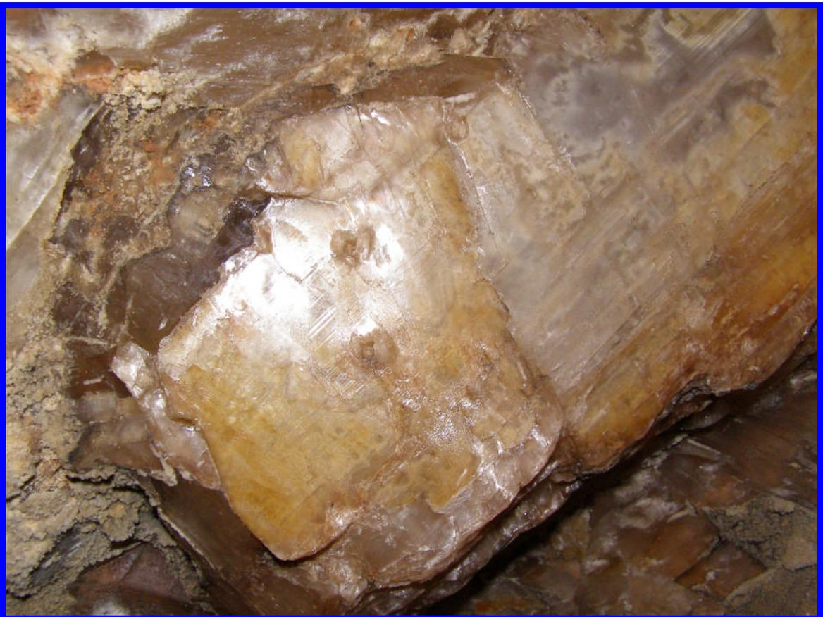
**Foto-8:** Placa de yeso especular con huellas de puntero cuadrangular en el interior de la mina de “La Quebrada” en Valparaíso de Abajo (Campos del Paraíso-Cuenca).
